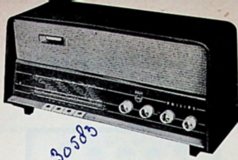
PHILIPS ONTVANGER type BSX92A met in de kastrand opgenomen druktoetsen en asymmetrische knoppen
