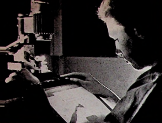
Afb. 73 - EINDCONTROLE van de gemonteerde naaldjes met een projectie microscoop
